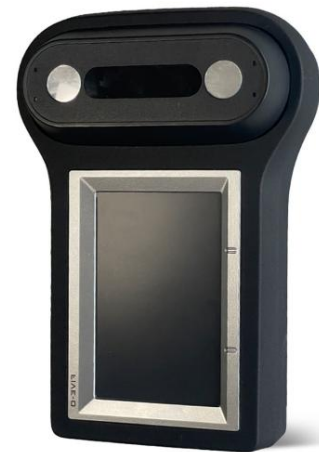
與設備無關的硬體週邊設備, 包含 IB Five-O FAP 50 指紋掃描器和 Iritech 雙眼虹膜掃描儀
